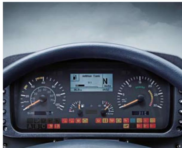
Die Instrumentierung: klar und übersichtlich gegliedert, mit bedienerfreundlichem Fahrer-Informationssystem, hinterleuchteten Ziffernblattanzeigen und 2 LCD-Multifunktionsanzeigen
