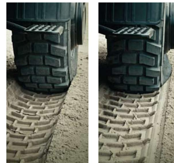
Mit tirecontrol können Sie den Reifendruck während der Fahrt an das Gelände anpassen – einfach per Schalter
