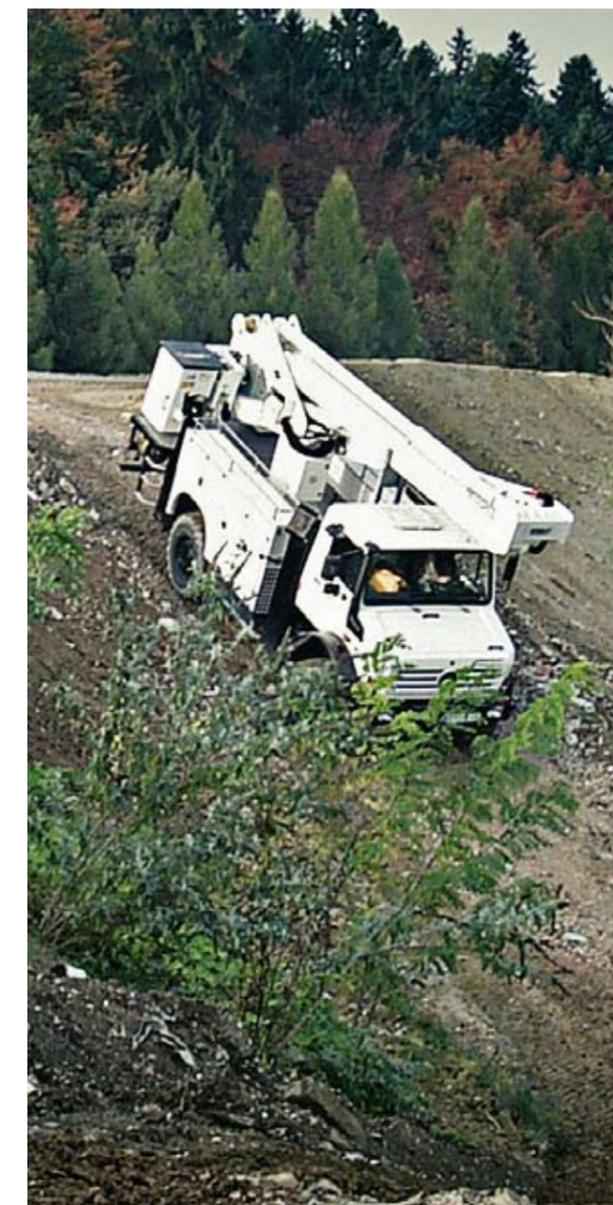
Scheibenbremsen und das abschaltbare ABS an allen 4 Rädern bieten Sicherheit im Gelände – auch mit schweren Fahrzeugaufbauten
