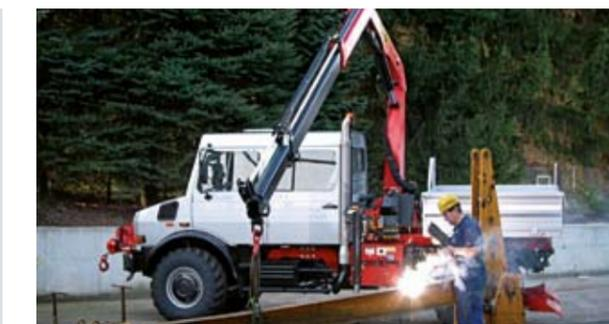
Ein genormter Anschluss am Schaltgetriebe ermöglicht die Verwendung handelsüblicher Hydraulikpumpen, z. B. für einen Kran
