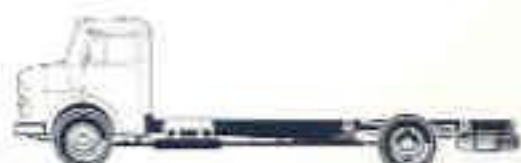
L 1313, wielbasis 517 cm, bruto laadvermogen 9070 kg, laadbaklengte 5,45 - 5,82 m.
