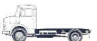
LA 1313, trekkerchassis, wielbasis 360 cm, bruto koppellingsdruk ca. 8500 kg, max. trekgewicht 24.000 kg.
