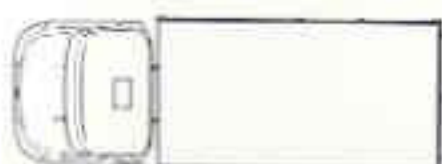
L 1313, wielbasis 420 cm, bruto laadvermogen 9185 kg, laadbaklengte 4,00 - 4,20 m.
