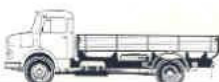
LA 1313, wielbasis 420 cm, met 4 x 4 aandrijving, bruto laadvermogen ca. 8650 kg, laadbaklengte ca. 4,35 m.
