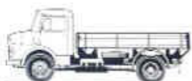
LA 1313, wielbasis 360 cm, met 4 x 4 aandrijving, bruto laadvermogen ca. 9000 kg, laadbaklengte ca. 3,30 m.
