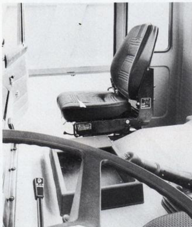
La strumentazione dell'Astra "BM 305 FTP" (in alto) comprende, oltre agli indicatori normalmente utilizzati sui veicoli industriali, il contagiri con contatore totalizzatore. Nonostante la notevole altezza da terra - circa 142 centimetri - tre gradini (sotto a sinistra) facilitano l'accesso in cabina. Due sedili molleggiati fanno parte della dotazione di serie.
