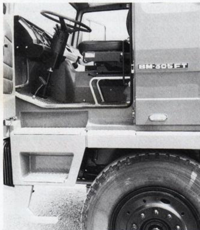
La strumentazione dell'Astra "BM 305 FTP" (in alto) comprende, oltre agli indicatori normalmente utilizzati sui veicoli industriali, il contagiri con contatore totalizzatore. Nonostante la notevole altezza da terra - circa 142 centimetri - tre gradini (sotto a sinistra) facilitano l'accesso in cabina. Due sedili molleggiati fanno parte della dotazione di serie.
