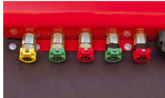
**Verschiedene klar markierte Hydraulikan schlüsse erweitern das Einsatzspektrum des TP48.**
